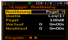
Abbildung 64: Display Trigger Logger Auslöse Pegel
