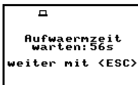
Abbildung 7: Display direkt nach dem Einschalten des SVAN 979 mit Anzeige der Aufwärmzeit
