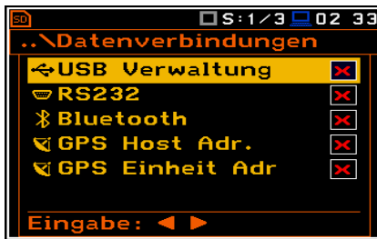
Abbildung 93: Display USB Anschluss
