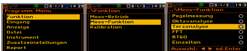
Abbildung 75: Display Mess-Funktion mit gewählter Terzanalyse
