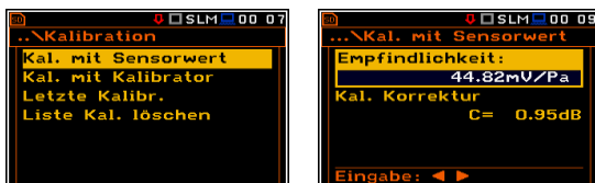
Abbildung 15: Display Kalibrierung mit Sensorwert
