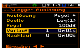
Abbildung 63: Display Trigger Logger Vorlauf
