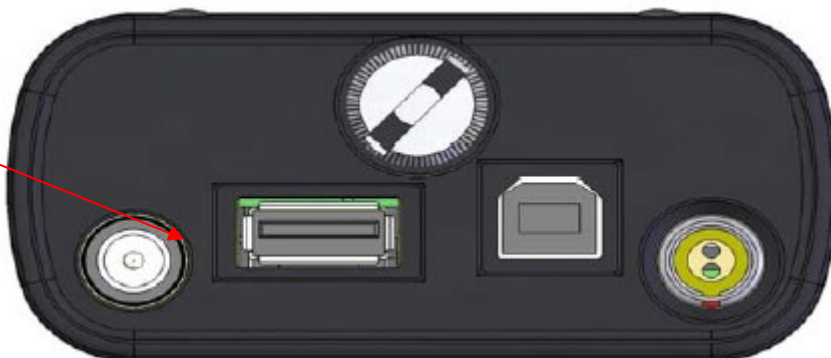
Abbildung 101: Netzanschluss des SVAN 979
