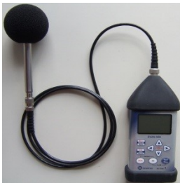
Abbildung 6: SVAN 979 mit abgesetzter Mikrofon-Verstärkereinheit und Windschirm
