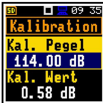
Abbildung 9: Kalibriermenü mit Eingabe des Kalibrierpegels
