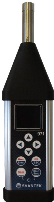
Abbildung 4: SVAN 971 mit aufgeschraubter Mikrofon-Verstärkereinheit und Windschirm
