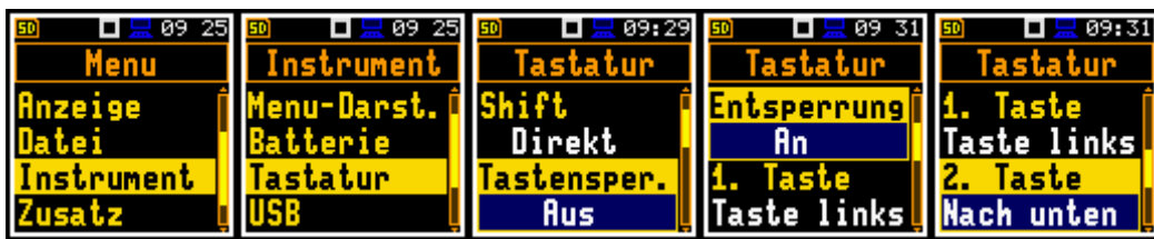
Abbildung 3: Einstellen der Tastatursperre des SV 971
