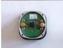
c) Abdeckung abnehmen und leere Batterien entfernen.
