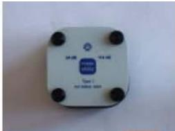
a) Entfernung des Gummischutzes von der Tasten- u. Dioden-Seite
