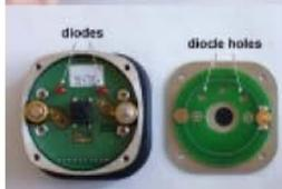
e) Abdeckung mit den Löchern für die Dioden aufsetzen.
