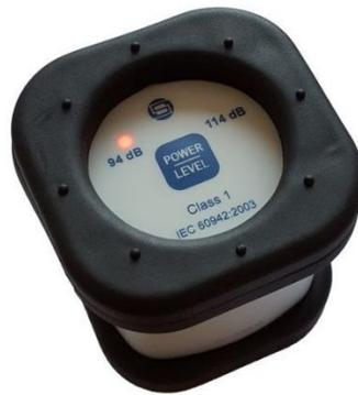
Anhaltende abwechselnd blinkende Dioden zeigen eine schwache Batterie an. Es wird empfohlen den SV 36 Kalibrator nicht zu benutzen, da der erzeugte Pegel tiefer als der angezeigte Wert sein könnte.
