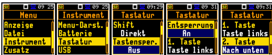
Abbildung 3: Einstellen der Tastatursperre des SV 971A
