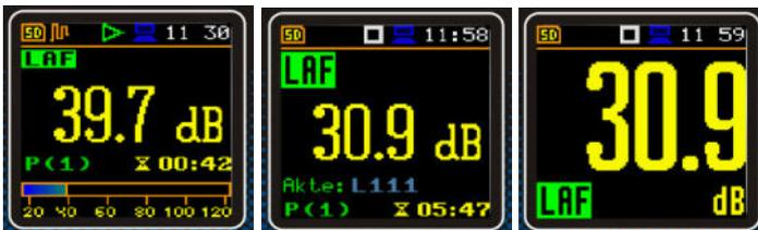
Abbildung 29: Anzeige nach dem Start der Messung
