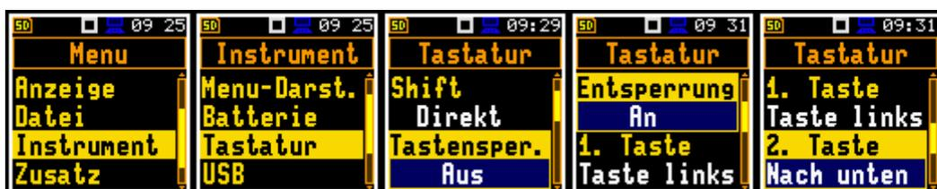
Abbildung 3: Einstellen der Tastatursperre des SV 971A
