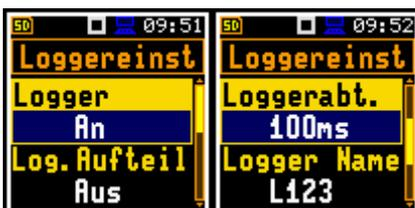
Abbildung 40: Einstellungen des Logger-Setups
