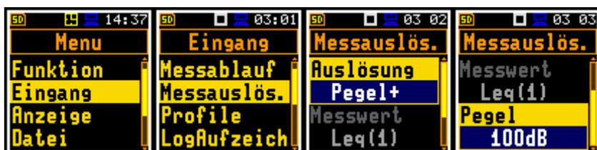
Abbildung 46: Anzeige Triggereinstellungen Messung
