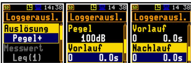
Abbildung 49: Anzeige Trigger Pegel +
