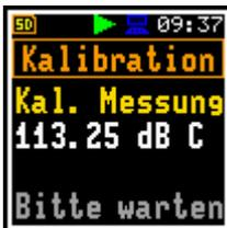
Abbildung 11: Anzeige während des Kalibriervorgangs
