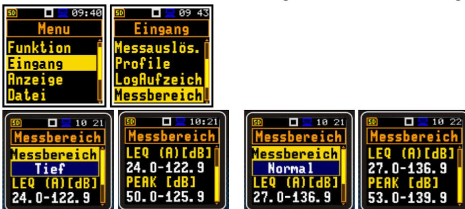
Abbildung 23: Anzeige Messbereichseinstellung (rechts beide Messbereiche)
