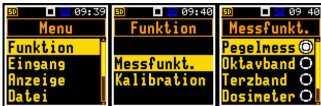
Abbildung 53: Anzeige Messfunkt. mit Auswahlmöglichkeit Terzanalyse „Terzband“
