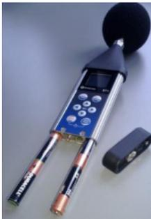
Abbildung 68: Batterietausch
