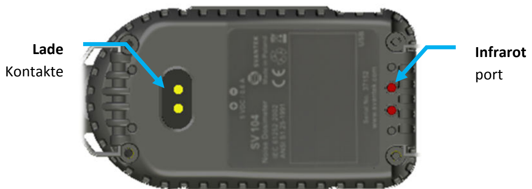
Abbildung 4: SV 104IS Rückansicht – Ladeanschluss und möglicher Infrarot-Port (noch nicht implementiert)
