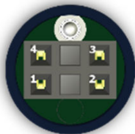
Abbildung 80: SV 27IS Mikrofonstecker (Draufsicht auf das Gerät)
