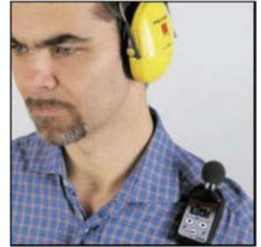
Abbildung 37: SV 104IS Positionierung
