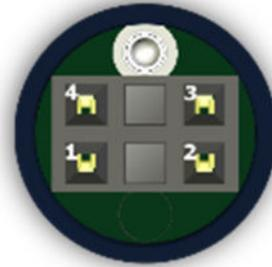
**Abbildung 80:** SV 27IS Mikrofonstecker (Draufsicht auf das Gerät)
