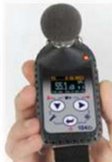
**Abbildung 1:** SV 104IS Dosimeter mit Mikrofon und Windschirm
