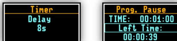
Abbildung 35: Auto-Run Modus. Links das Timer Display – Rechts die prog. Pause
