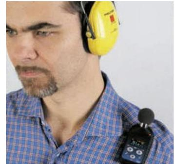
Abbildung 36: SV 104 Positionierung
