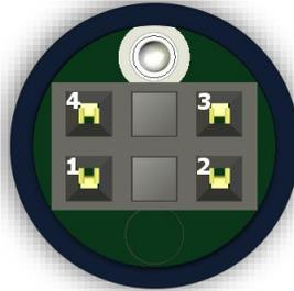
**Abbildung 79:** SV 27 Mikrofonstecker (Draufsicht auf das Gerät)
