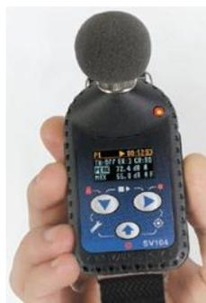
**Abbildung 1:** SV 104 Dosimeter mit Mikrofon und Windschirm
