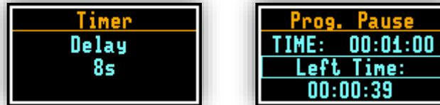
Abbildung 34: Auto-Run Modus. Links das Timer Display – Rechts die prog. Pause
