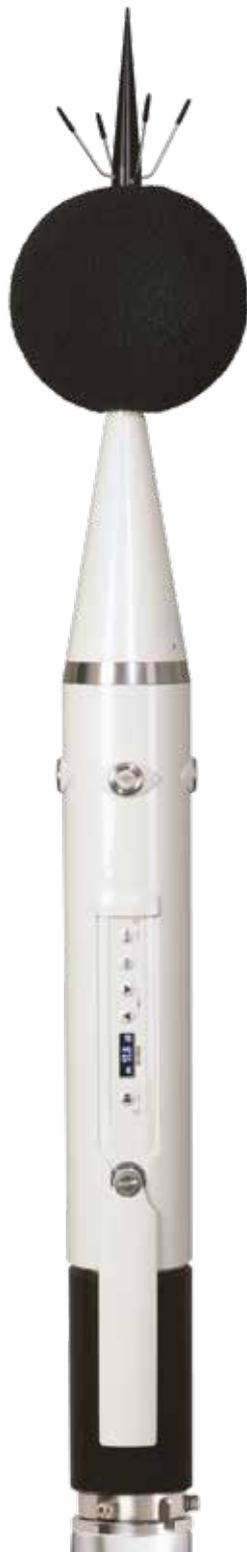
Gemäß den Anforderungen der **ISO 1996-2** verwendet die SV 200A einen **elektrostatischen Aktuator**, um eine regelmäßige Systemprüfung durchzuführen. Die Überprüfung der gesamten Messkette einschließlich des Mikrofons ist der Vorteil der elektrostatischen Aktuatormethode.
