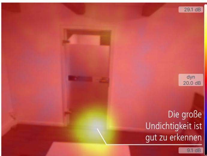
Ergebnis der SoundCam 2.0, dem Vorgängermodell der SoundCam 3. Dies ist eine sehr gute akustische Kamera mit 64 Mikrofonen. Die große Undichtigkeit wird sehr gut erkannt. Die kleine Undichtigkeit wird nicht erkannt, da sie im Bildrauschen verschwindet.
