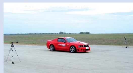
Vorbeifahrtmessungen beim Reifenhersteller Cooper Tire, USA
